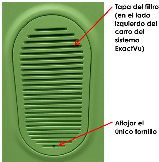
**Figura 72. Vista interior del panel lateral izquierdo**
