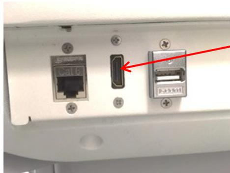
**Conector (HDMI) de salida del segundo monitor**
